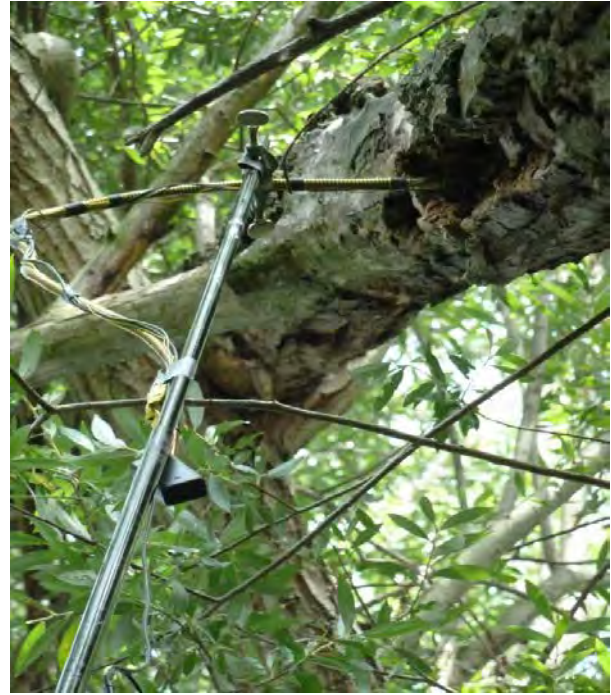
Abbildungen 3 und 4 Einsatz der Baumkamera auf Teleskopstab (Bsp. Fotos: M. Stauss)
